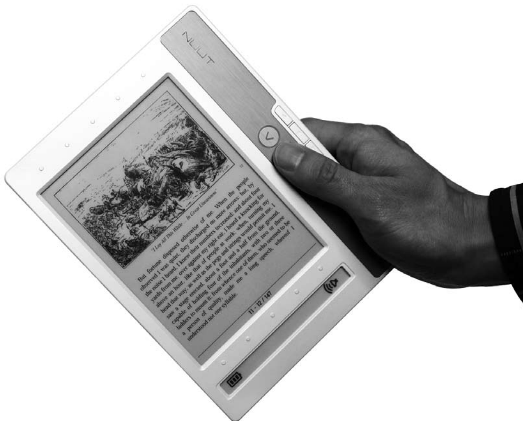
Nuut 2. Sydkoreansk läsplatta som börjar säljas i Sverige hösten 2009. Klarar de viktigaste e-boksformaten och har stöd för kopieringsskydd. Har möjlighet att spela upp ljudspår. Saknar pekskärm och trådlös uppkoppling. 14 x 17 centimeter, tre centimeter tjock på bredaste stället. Väger 300 gram. Pris cirka 3 000 kronor.
